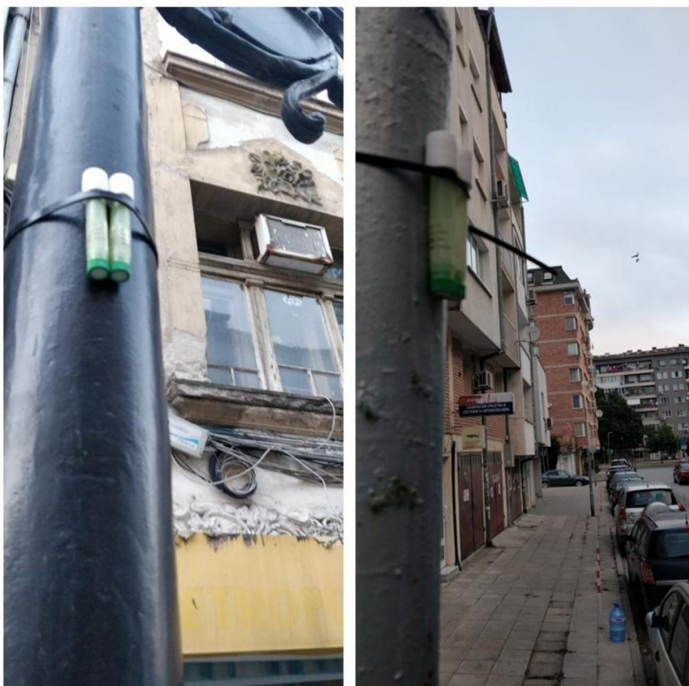
Фигура 15. Монтирани двойки тръби за измерване на азотен диоксид в два измервателни пункта в град Пловдив Забележка: Източник – Собствен архив на проекта.
